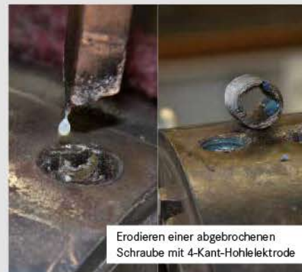
Erodier-Reste eines abgebrochenen Bohrers nach Erodiervorgang mit Elektrode in Sonderlänge 500 mm
