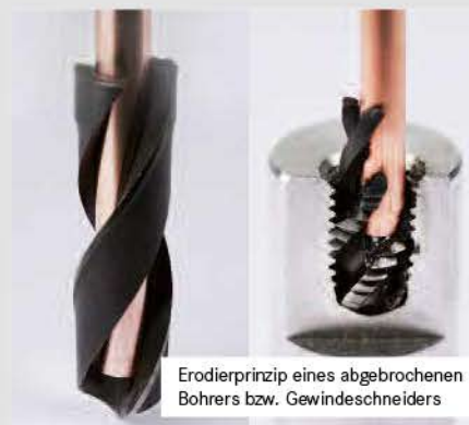
Erodier-Reste eines abgebrochenen Bohrers nach Erodiervorgang mit Elektrode in Sonderlänge 500 mm
