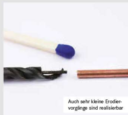
Erodierprinzip eines abgebrochenen Bohrers bzw. Gewindeschneiders
