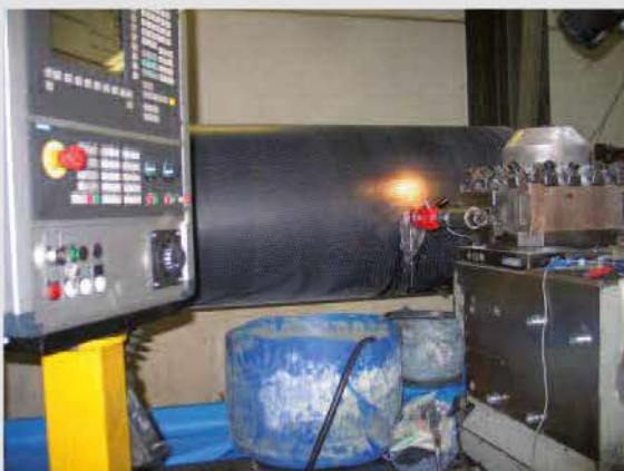
Horizontales Erodieren an einer CNC-Drehmaschine. Die Vorschubregelung erfolgt manuell über das Handrad
