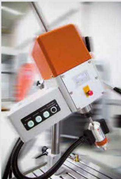
Erodieren von schrägen Bohrungen
