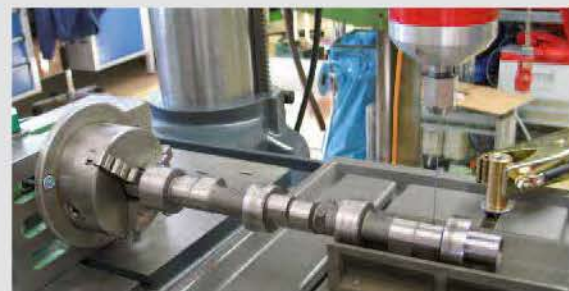
Erodieren einer Nockenwelle. Anstelle des Bohrers wird der Schwingkopf des Erodiergerätes in die Maschine gespannt
