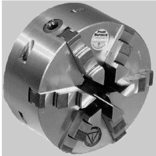
Unser Griptru-Planspiralen-Handspannfutter ist in **3- und 6-Backen-Ausführung** lieferbar. Mit Hilfe von 3 Einstellschrauben kann das Werkstück im Rundlauf eingestellt werden. Es wird ein **Rundlauf von 5/1000 mm** garantiert.
